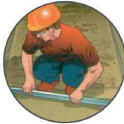
Formazione del piano di posa con adeguate pendenze mediante staggiatura
